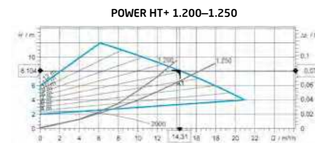
Расход-напор насоса из гидравлического комплекта POWER HT+ 200–250 кВт + кривая гидравлического сопротивления теплообменника.
