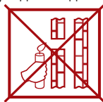
недостаточная тяга (Не используйте котел!)
