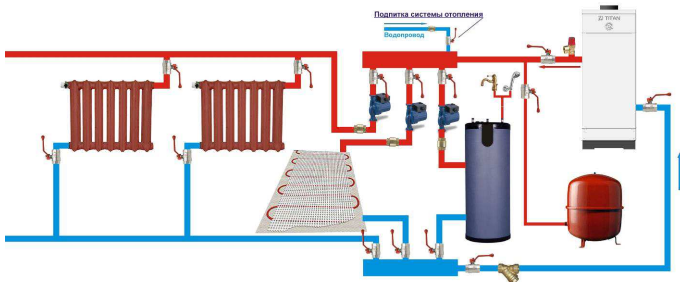
Рисунок 6. Схема подключения котла с общим коллектором
