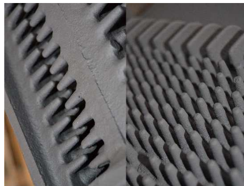
Рисунок 1. Внешний вид поверхностей теплообменника
