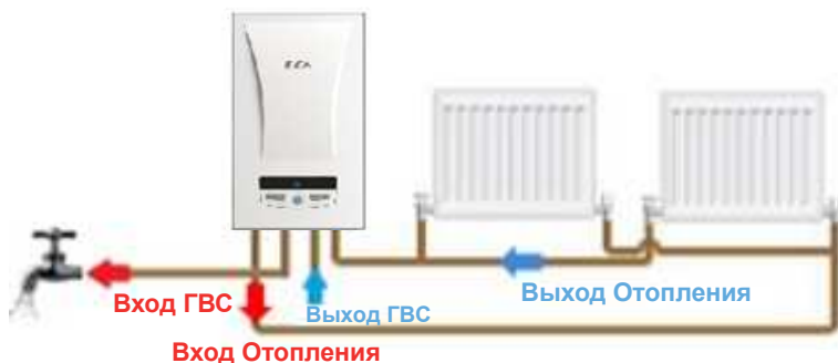
Рисунок 7. Схема Подключения Установки Монотермического Устройства.
