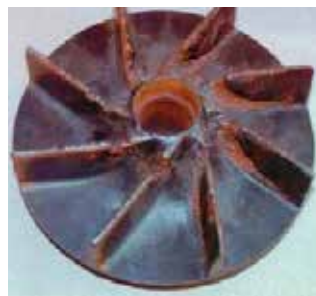
Повреждение крыльчатки насоса
