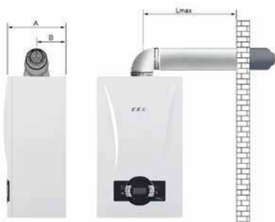
Горизонтальный коаксиальный дымоход Максимальная длина L макс. : 10 м, Ø60/100 Максимальная длина L макс.: 20 м, Ø80/125
