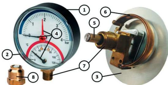
Чувствительный элемент термометра представляет собой пластину, выполненную из двух спрессованных друг с другом различных металлов, имеющих разные коэффициенты линейного расширения. Пружина одним концом прикреплена к штоку, другой конец пружины жестко соединен со стрелкой термометра. При изменении температуры пружина раскручивается, поворачивая за собой стрелку.
