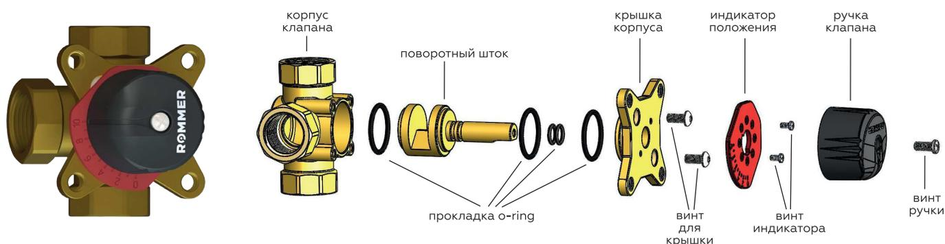
Клапаны ROMMER имеют три патрубка для присоединения к трубопроводу (два входных и один выходной) для смешивания двух потоков сред с различными параметрами в один.
