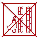
слабая тяга (Не используйте котел!)
