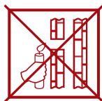
недостаточная тяга (Не используйте котел!)
