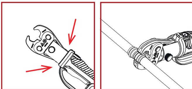
Нажмите кнопку «ПУСК» и выполните соединения. В случае ошибки, нажмите кнопку принудительного реверса и вручную верните поршень в исходное положение. По окончании цикла опрессовки, поршень автоматически вернется в исходное положение. Снимите пресс-насадку с фитинга.
