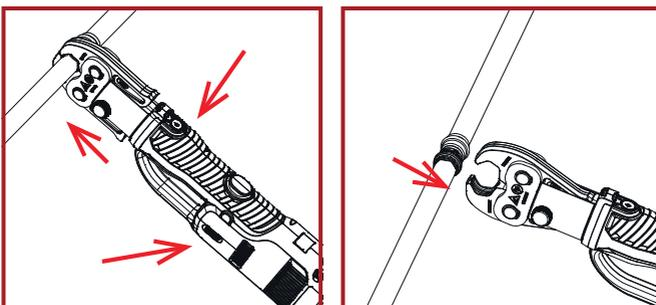
После завершения работы с инструментом нанесите каплю машинного масла на ролики штока. Перед укладкой в чемодан протрите инструмент сухой ветошью.
