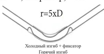
\*Методом горячего изгиба - разогрейте трубу строительным феном до температуры 130 °С. В местах поворота трубы следует крепить хомутами или скобами с шагом 10 см, в противном случае труба выпрямится (эффект памяти).
