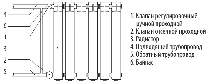
Комплект радиаторный ручного регулирования R706K прямой (пример подключения)
