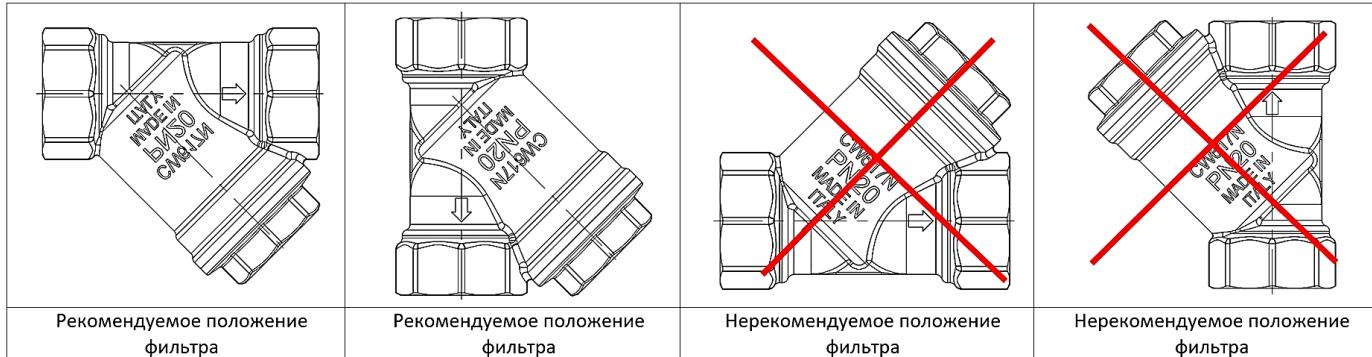
В соответствии с ГОСТ 12.2.063 п. 3.10, трубопроводная арматура не должна испытывать несоосность патрубков, неравномерность затяжки крепежа. При необходимости должны быть предусмотрены опоры или компенсаторы, снижающие нагрузку на арматуру от трубопровода.
