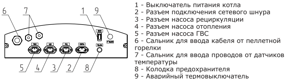
Рис.6. Расположение органов управления на задней панели пульта.
