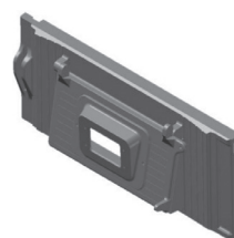
Рис. 3. Регулировочная дверца подачи первичного воздуха
