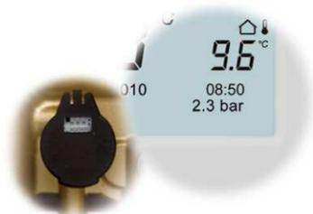
Электронный датчик давления воды в системе, интегрированный в гидравлический узел котла, позволяет постоянно следить за этим показателем на ЖК-дисплее панели управления. В случае падения давления воды в системе котел выдает предупреждение в 2 этапа. В случае не критического снижения давления на дисплее появится предупреждение, дальнейшее снижение вызовет блокировку котла.
