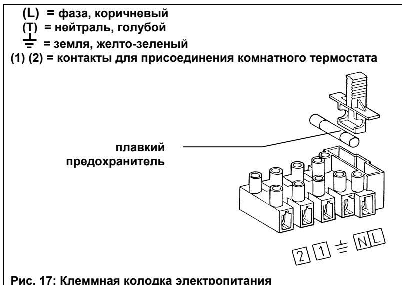
Рис. 17: Клеммная колодка электропитания
