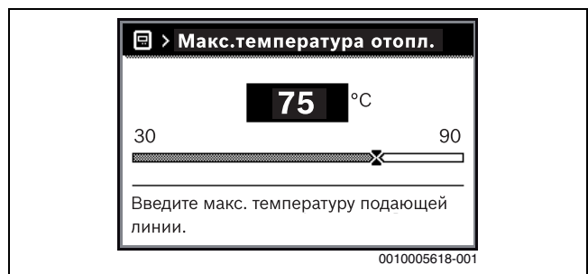
Рис. 7 Установка максимальной температуры подающей линии
