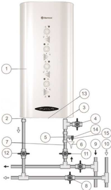
Рисунок 1. Схема подключения ЭВН к водопроводу в вертикальном положении
