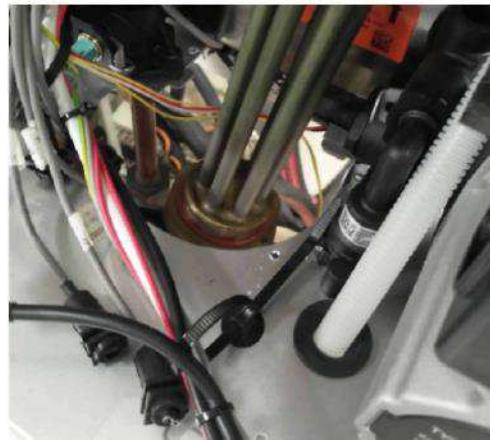
Подходящий ручной инструмент: Гаечный ключ AA 62 или зажимная втулка сопротивления 7006250177
