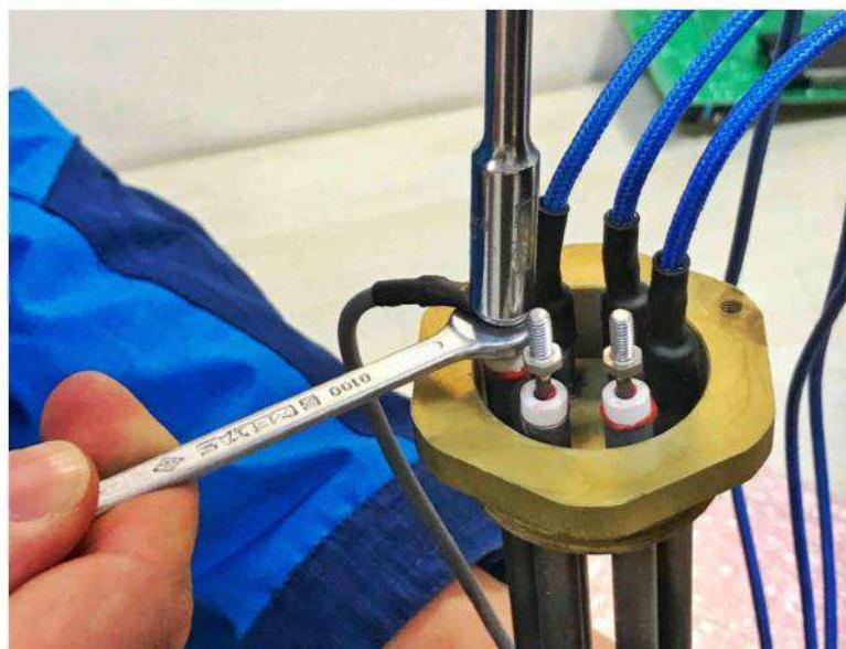
При затягивании фазных проводов необходимо установить шайбу M4, кольцевую клемму, пружинную шайбу M4 и гайку M4 соответственно. Поворачивая гайку с гнездом с верхней стороны, клемму резистора следует зафиксировать ключом на 1/4 дюйма с нижней стороны.
