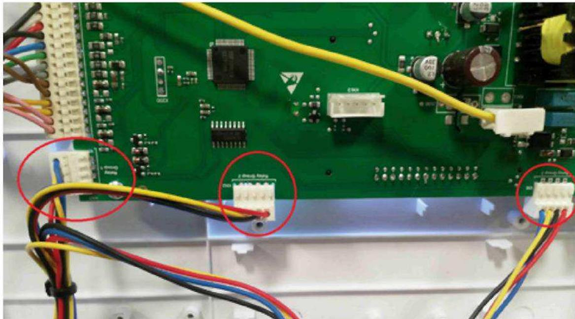
e- Если соединения выполнены правильно, отключите входное электропитание устройства от предохранителя, снимите провода резисторов, не проводящих ток, с релейных плат, снова разомкните предохранитель и переведите устройство в тестовый режим с помощью Ключи К3 и К5. Когда устройство находится в тестовом режиме, измерьте сопротивление между контактами, где вы отсоединили провода. Если вы видите, что сопротивление между контактами реле близко к 0, плата реле и материнская плата в порядке.
