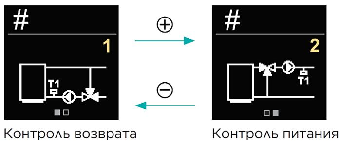
В данном меню выбирается гидравлическая схема для работы привод. Для перемещения между схемами используйте кнопки  $\ominus$  и  $\oplus$ . Выбранная схема работы подтверждается кнопкой  $\odot$ . Если случайно выбрана неверная схема, для возврата в меню выбора необходимо использовать кнопку  $\odot$ .
