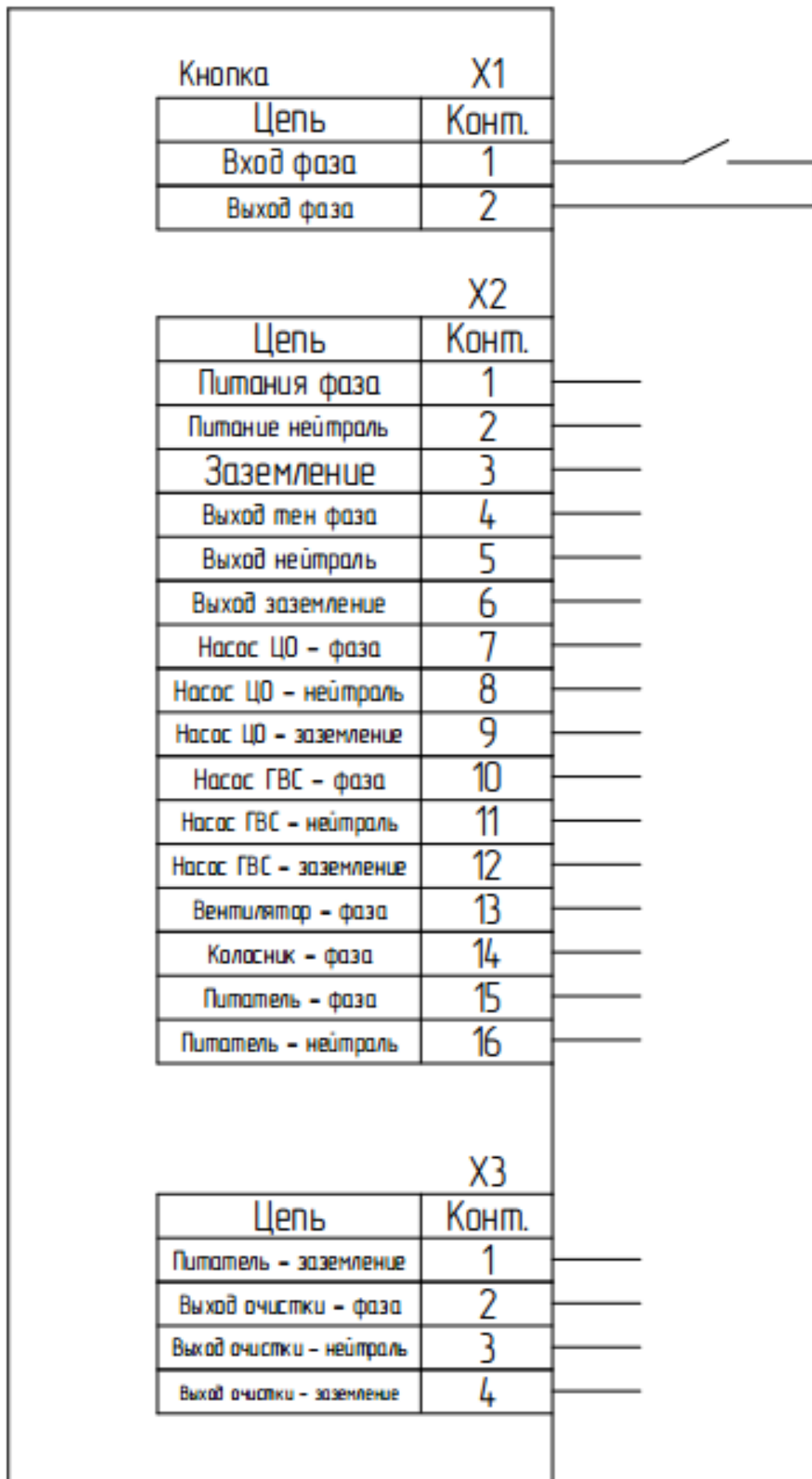
Рис. 8 – Подключение цепей на силовой плате БУ
