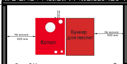
Рис. 6 Установка котла в котельной
