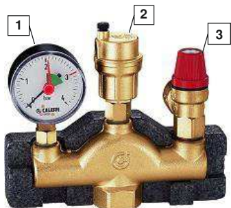
Рисунок 2. Группа безопасности котла: 1 - манометр, 2 - автоматический воздухоотводчик, 3 - предохранительный клапан
