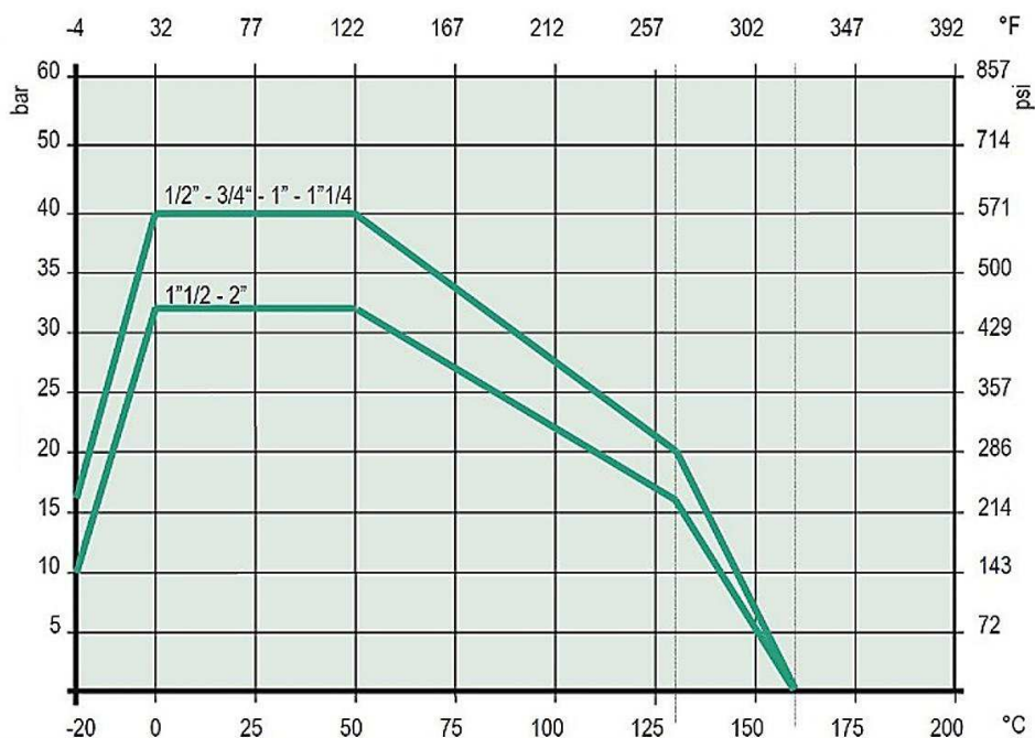
РИС.1.1. ЗАВИСИМОСТЬ РАБОЧЕГО ДАВЛЕНИЯ ОТ ТЕМПЕРАТУРЫ ПЕРЕМЕЩАЕМОЙ СРЕДЫ
