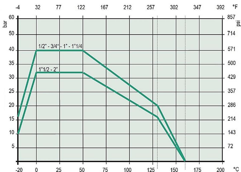
РИС.1.1. ЗАВИСИМОСТЬ РАБОЧЕГО ДАВЛЕНИЯ ОТ ТЕМПЕРАТУРЫ ПЕРЕМЕЩАЕМОЙ СРЕДЫ
