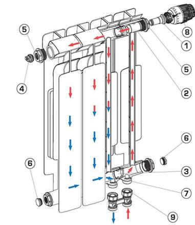
Рис. 1. Устройство радиатора
