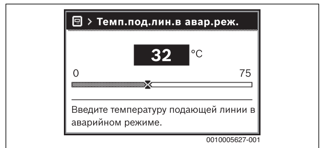
Рис. 30 Температура подающей линии для аварийного режима
