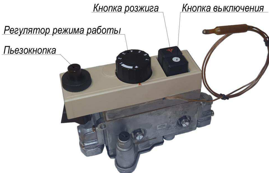
Рисунок 7.1 – элементы управления газового клапана с пьезорозжигом
