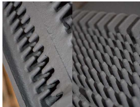
Рисунок 1. Внешний вид поверхностей теплообменника
