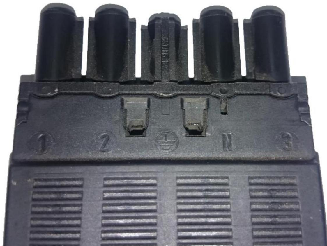
Рис. 7 – Разъем подключения горелки
