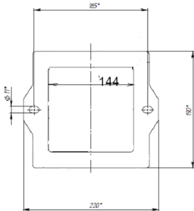
Рис.2 – Чертеж монтажных отверстий горелки
