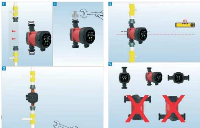
Для того чтобы при работе насос издавал минимум вибраций и шума, при подключении к трубопроводам его ось должна находиться в горизонтальном
